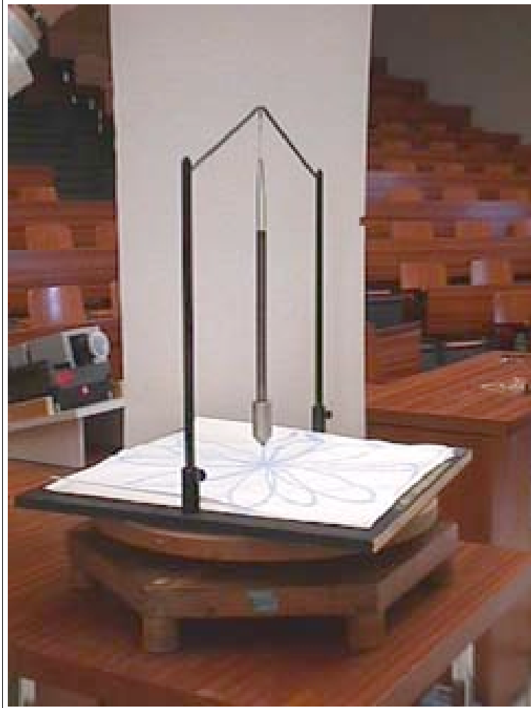
Abbildung 1: Modell des Foucault-Pendels
